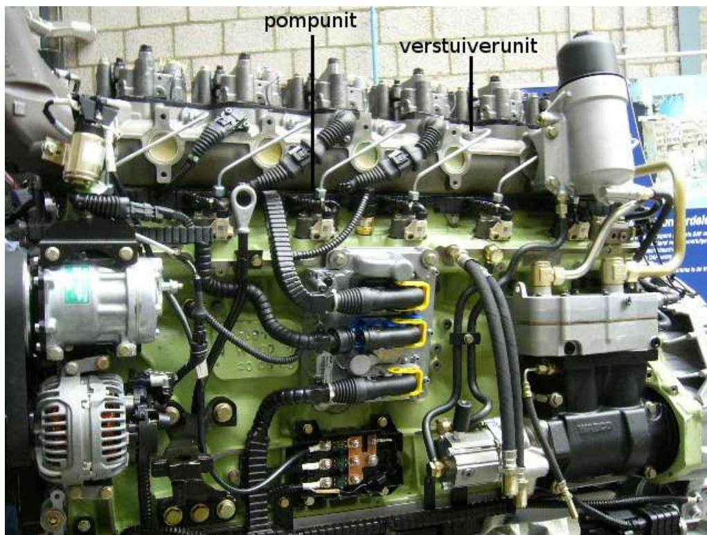
Figuur 11: Het DMCI motormanagementsysteem van DAF met pompunit, verstuiverleiding en verstuiver
