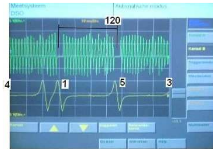
Figuur 18: Het oscilloscoopbeeld van het krukas- en nokkenassignaal van het DMCI-systeem van DAF.
